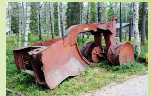
Lokomo metsäoja-aura 1950-luvun lopulta sopisi hyvin koko MERA-kauden symboliksi. Näillä ja vastaavilla laitteilla vallattiin märkiä turvemaita kasvuisiksi metsiksi.
