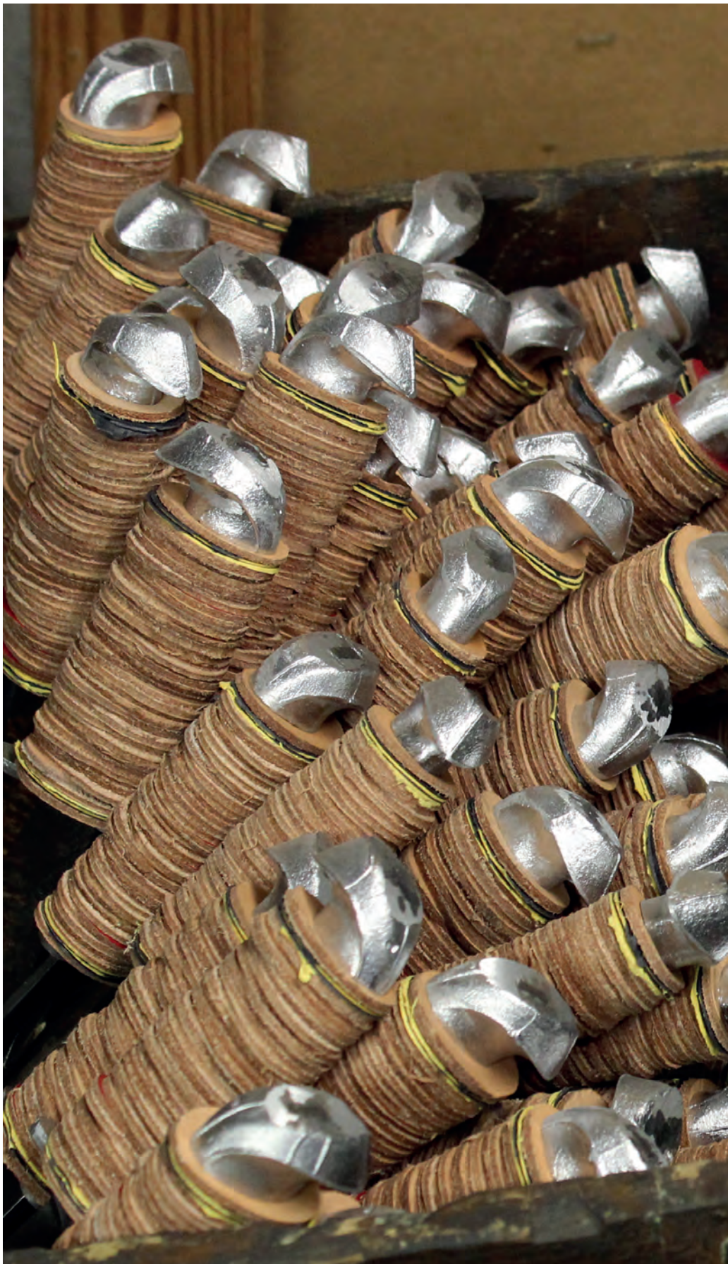
Puukkojen kahvoin on pujotettu muotoillut laput yksitellen käsin lisäksi Järvenpään puukkotehtaassa. Seuraava työvaihe odottaa. Takakannessa yhden hevospääpuukkomallin kahva valmiina. Kuva Antti Koskimäki.
