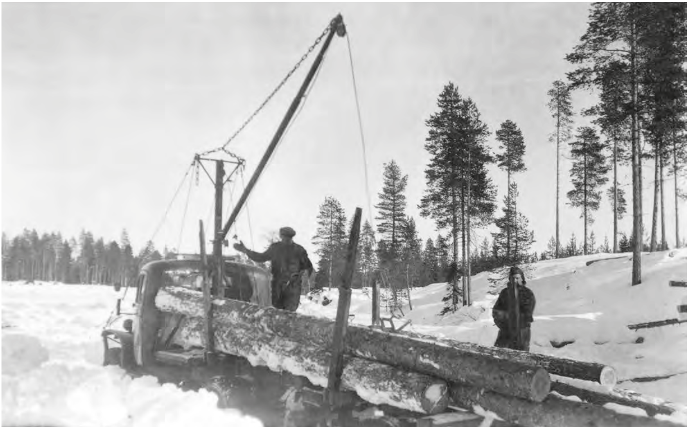
Tukkeja kuormataan puominosturin avulla Pielisjärven Hangasjärvellä Pielisjärven kunnassa vuonna 1952. Kuva Lusto, Ilmari Karvosen kokoelma, kuvaaja mahdollisesti Ilmari Karvonen.
