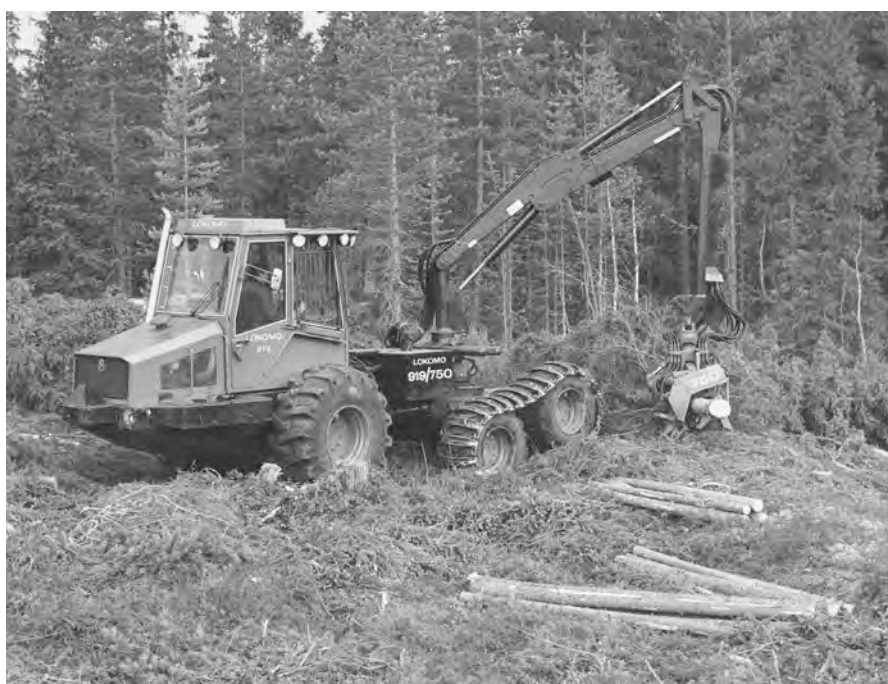
Lokomo 919/750 -kouraprosessori, valmistaja Rauma-Repola Oy, Lokomon tehtaast. Kuva Lusto, Suomen Metsäyhdistyksen kokoelma.
